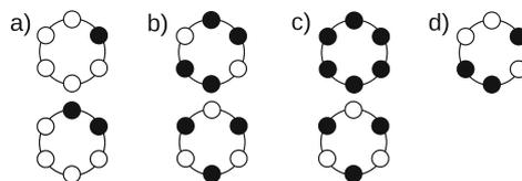
Abbildung 7: Spalte **a)** zeigt Zellen, die für die Signalübertragung verantwortlich sind, **b)** zeigt Zellen, die in einer *Kreuzung* verbaut sind, **c)** zeigt Zellen eines *CJoins* und **d)** zeigt die *Ratchet*-Zelle. Die schwarz markierten Anschlüsse zeigen eine Verbindung zu einer anderen Zelle an.
