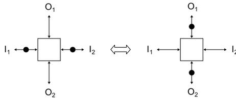
Abbildung 5: Die möglichen Übergänge in einem CJoin. Wenn auf beiden Eingangsleitungen ( $I_1$  und  $I_2$ ) ein Token anliegt, können diese simultan auf die Ausgangsleitungen ( $O_1$  und  $O_2$ ) wechseln. Die Rückrichtung ist anschließend auch möglich. Genau genommen gibt es keinen Unterschied zwischen Eingangs- und Ausgangsleitungen.
