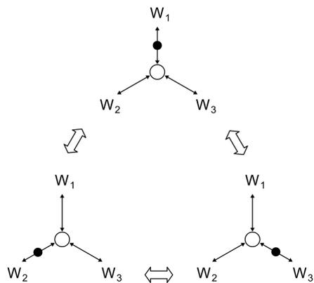
Abbildung 4: Die möglichen Übergänge in einem Hub. Das Token ist als schwarzer Punkt dargestellt. Durch Fluktuationen kann es zwischen den drei Leitungen  $W_1$ ,  $W_2$  und  $W_3$  wechseln.
